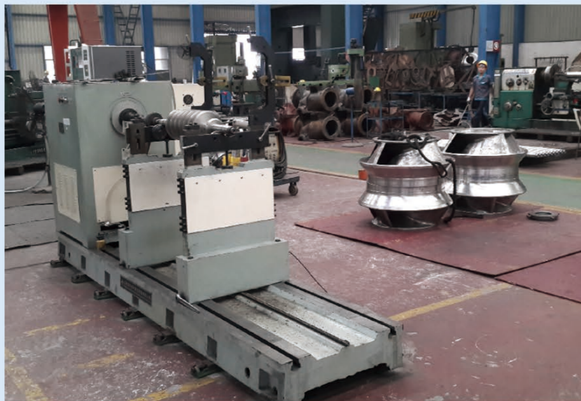
采用上海申克制造的动平衡设备，保证了产品的平衡运行。
