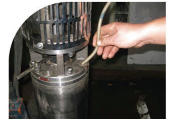
使用前给电机注水 Fill water before operating;
