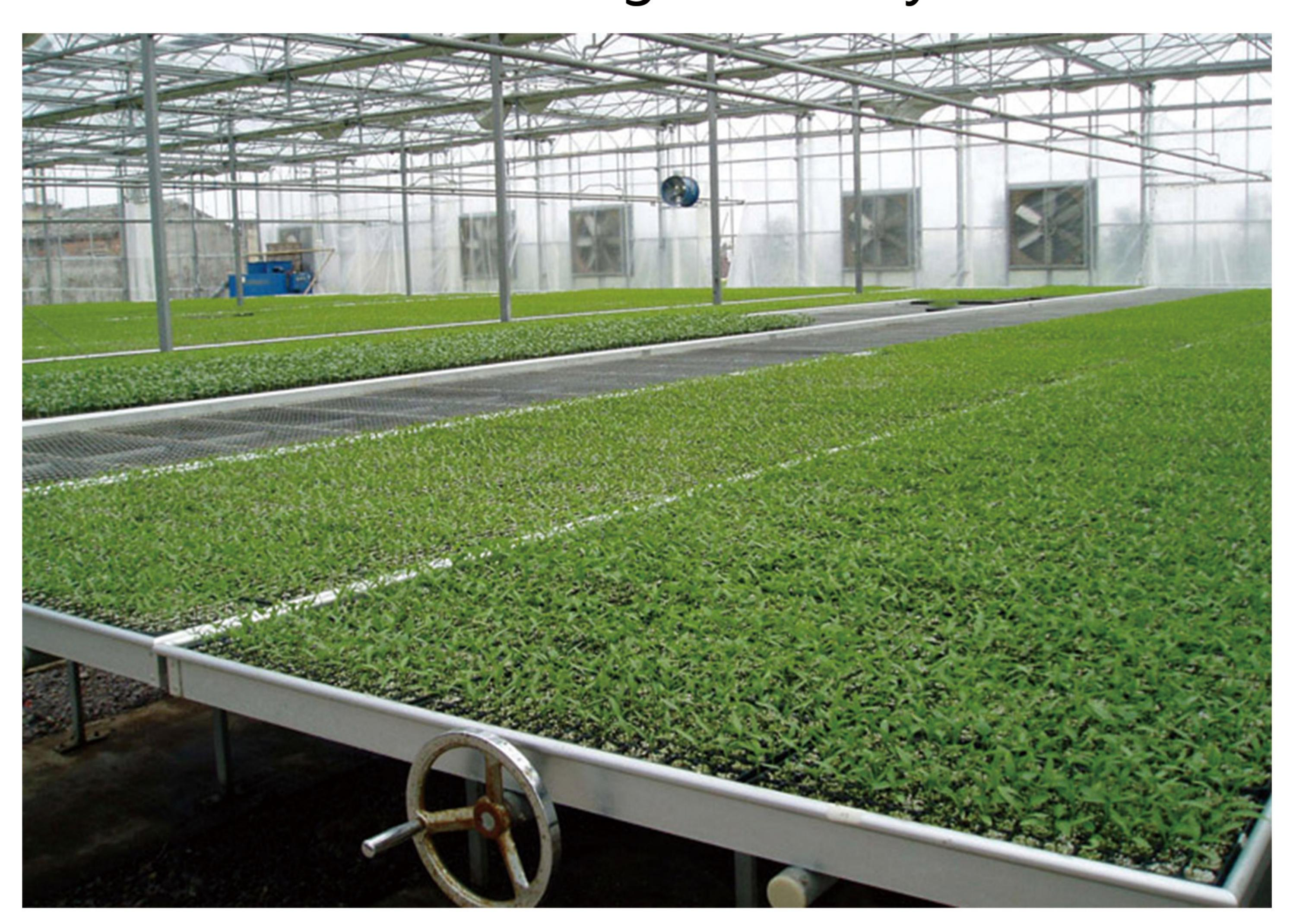
手动驱动,操作简便,移动方便。 苗床框架采用铝合金材质,钢管和支架的苗床网均采用热浸镀锌,耐腐蚀性强,承载能力强,使用寿命长。可长时间在潮湿的环境中使用。
