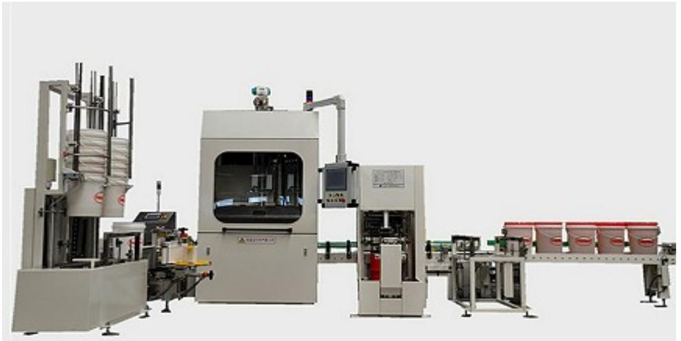
产品分为A51-1小开口桶自动灌装机、A51-2敞口桶自动灌装机。
