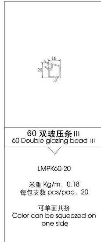
注：以上标注米重均为不带胶条米重，共挤胶条米重应增加单面 K 型 0.025Kg/m, 单面 O 型 0.037Kg/m
