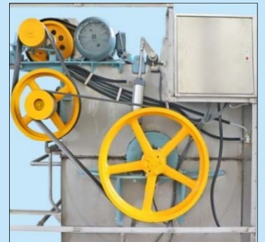
三級皮帶傳動 3-Stage Belt Drive
