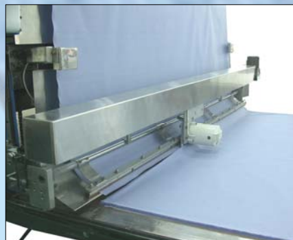
自動數碼定位布長，自動切布 Automatic Digital Fabric Length Positioning and Cutting
