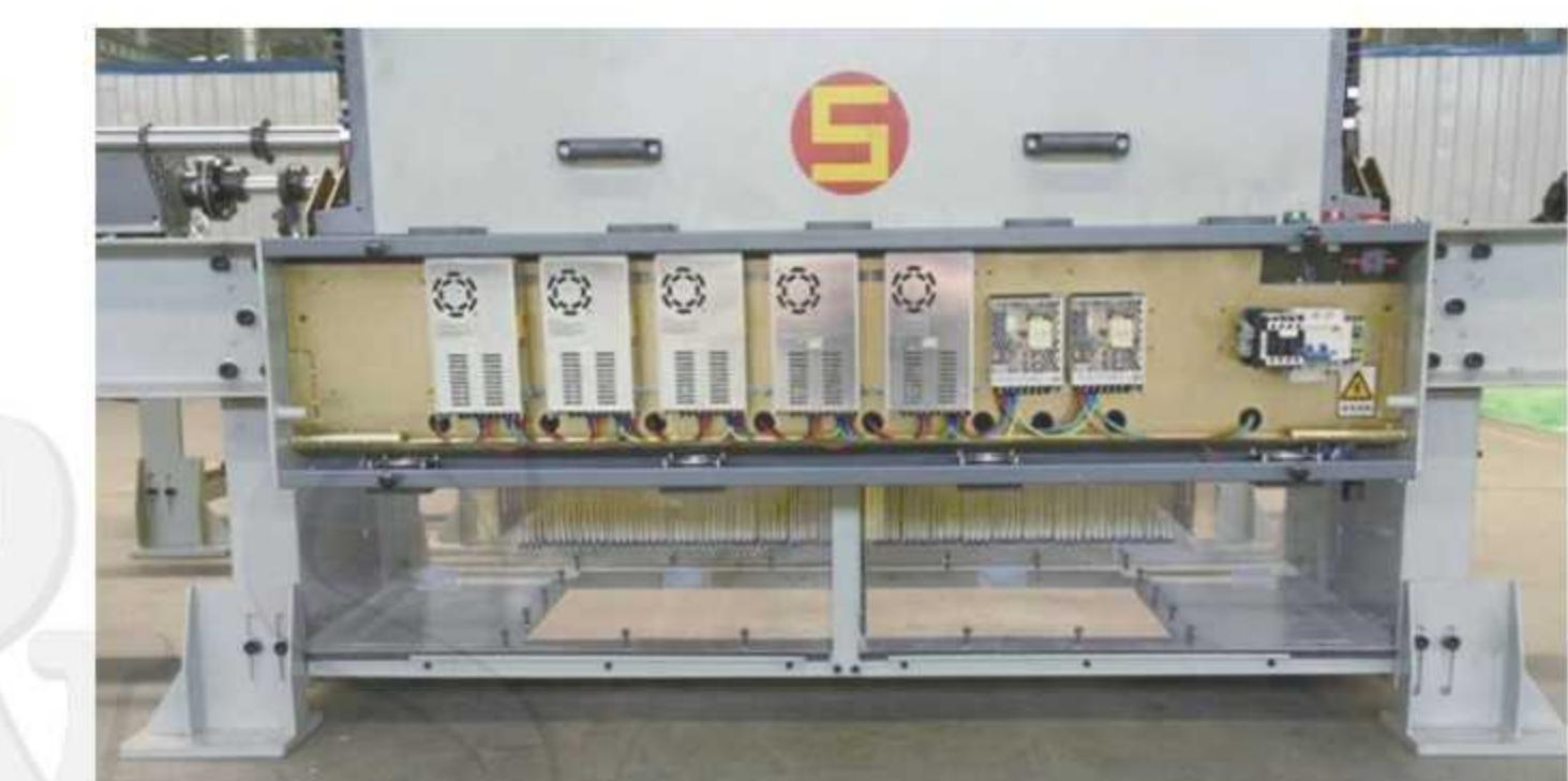
开关电源供电方式(电源供应器)
