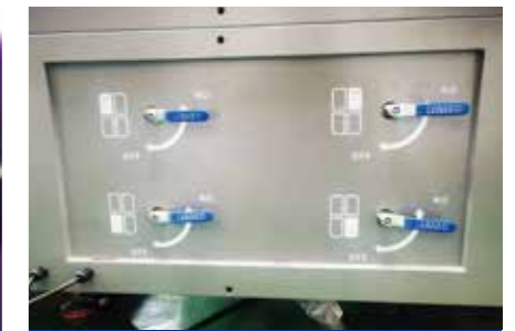
平台分区吸风功能 Platform partition suction function
