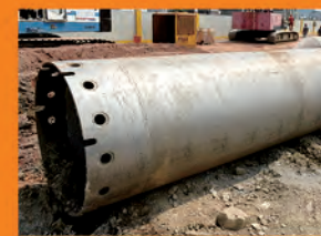
套管 Drive pipe
