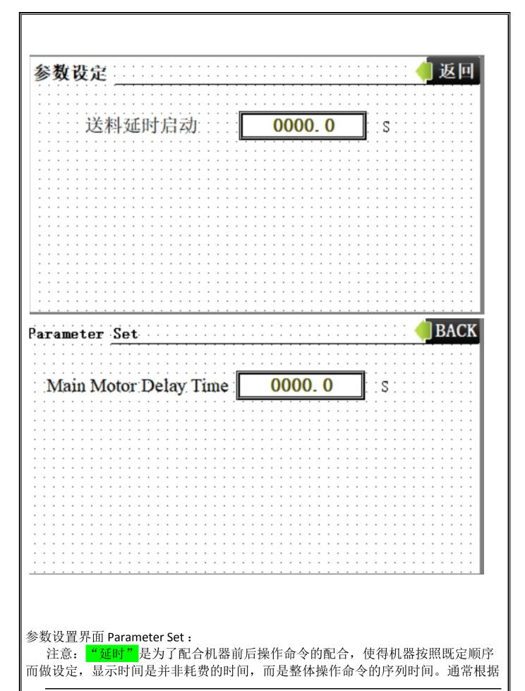
出厂设定即可,如需调整,则在不熟悉机器特性的情况下,根据前后动作的协调性进行±0.1的微调,多测试几次后进行相应调整。
