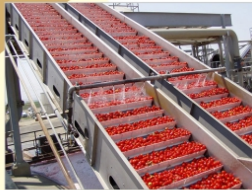
▲ Scraper Elevator 刮板式提升机
