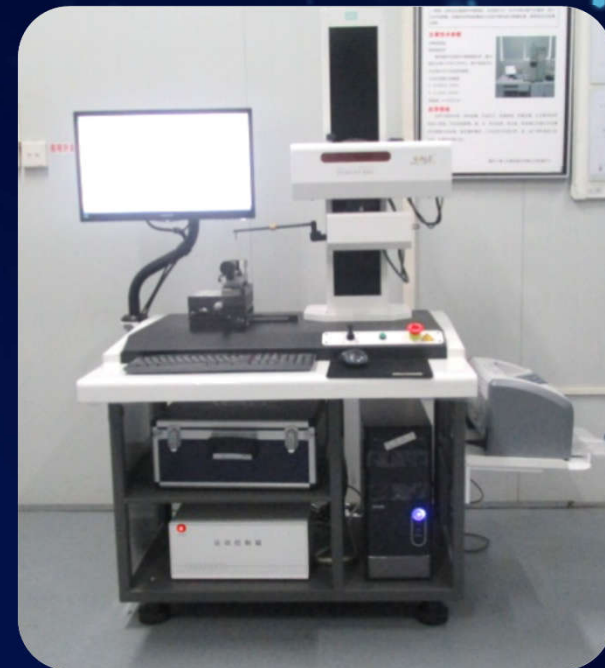
轮廓仪（影像轮廓测试与分析） Profilometer for image contour testing and analysis
