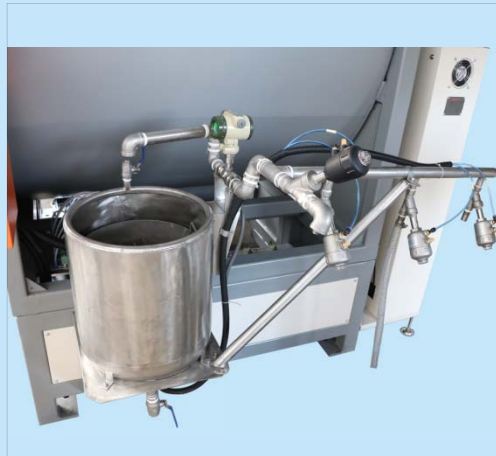
自動入藥水缸 Automatic chemical feeding tank
