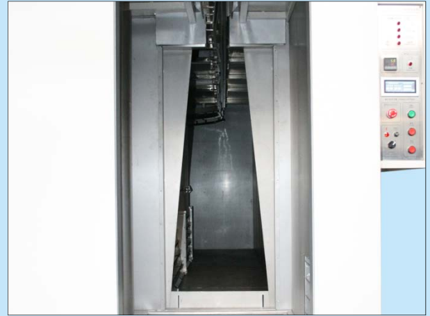
焗褲子時，擋板安裝示意圖 Diagram of baffle plate when curing trousers
